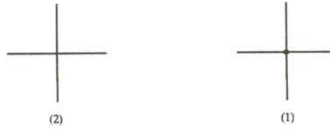
الشكل 3. تقاطع مسارين كهربائيين بوصلة أو دونها.
